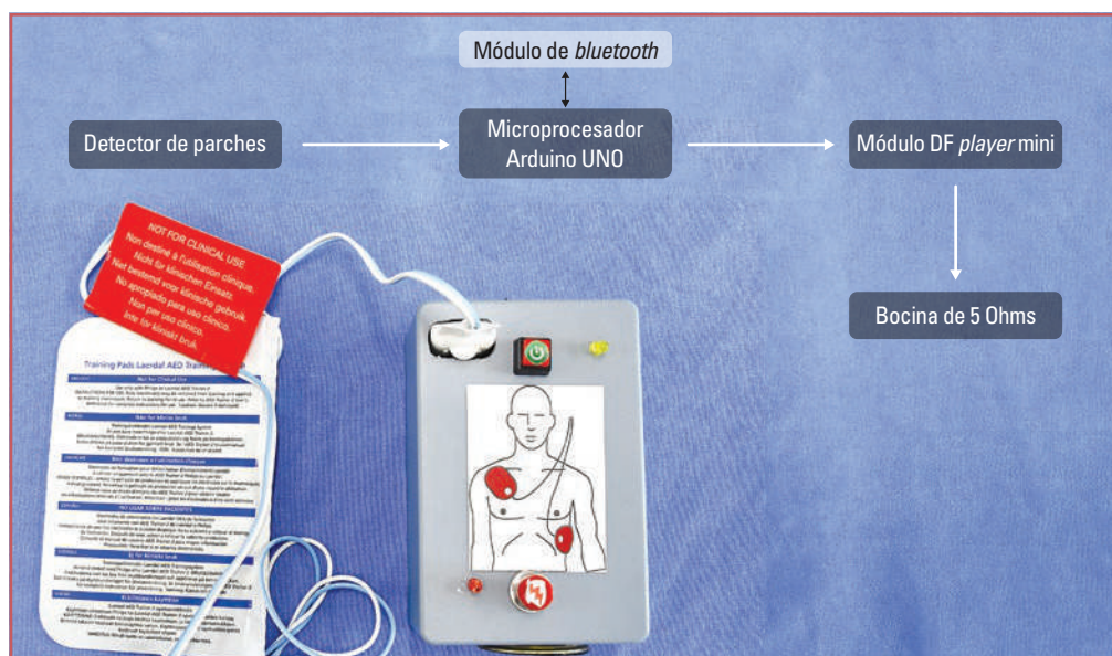
Figura 1. Diagrama y versión última del simulador de bajo costo. Se agregó un módulo bluetooth para control del dispositivo y para usarse como un selector de voces, manipulado a distancia para escenarios clínicos.
